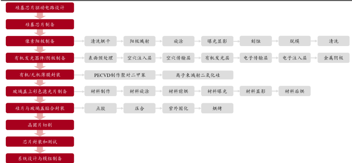
图表 52. 硅基 OLED 的工艺流程
